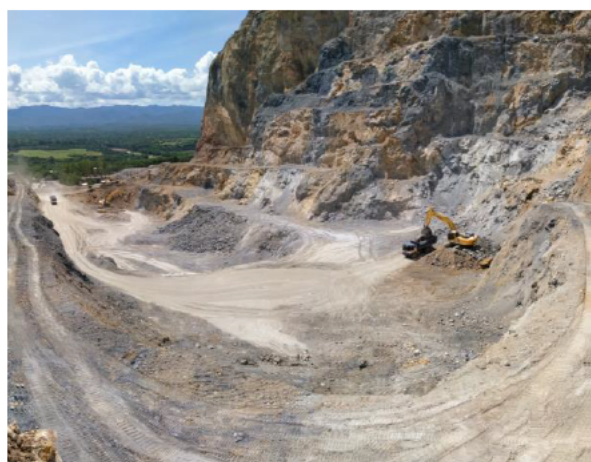
รูปที่ 2-2 (ต่อ) หน้าเหมืองที่มีการปรับแต่งให้เป็นไป ตามที่แผนผังโครงการกำหนด
