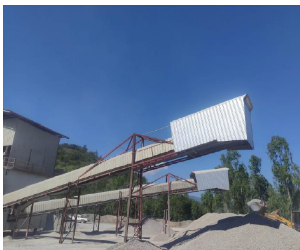
รูปที่ 2-18 การเปิดสเปรย์น้ำปลายสายพานโรงโม่
