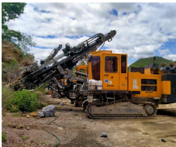
รูปที่ 2-3 เครื่องเจาะระเบิดที่มีระบบดักฝุ่น
