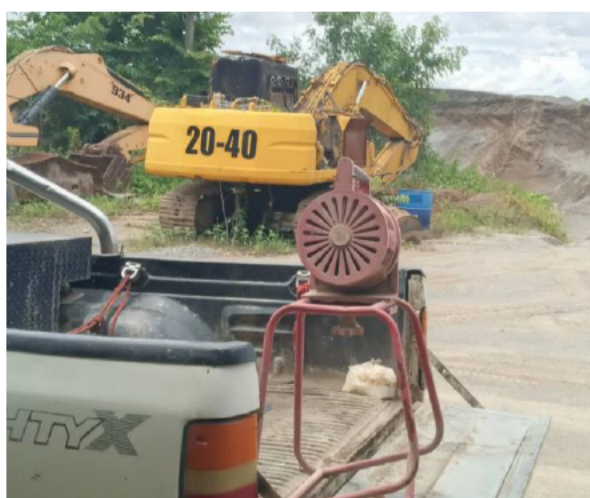
รูปที่ 2-37 ไชเรนที่ติดตั้งในพื้นที่สำหรับส่งสัญญาณ เตือนก่อนการระเบิด
