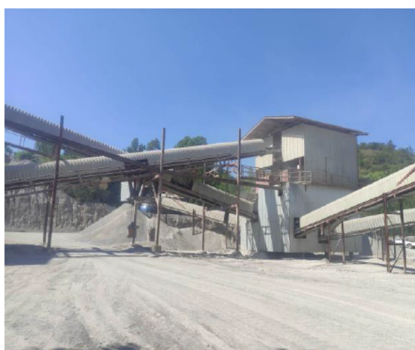
รูปที่ 2-17 โรงโม่หินของโครงการมีการจัดทำเป็นระบบปิด
